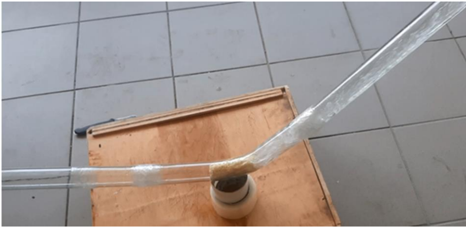
Рисунок 8 – Застрягання поршня із пінополіуретану більшої густини у відводі
