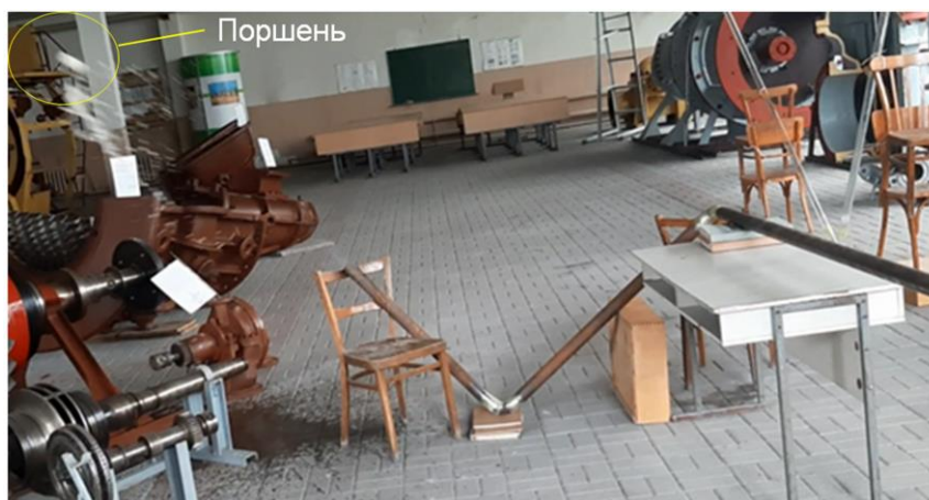
Рисунок 7 – Вилітання поршня із силіконового компаунда з трубопроводу
