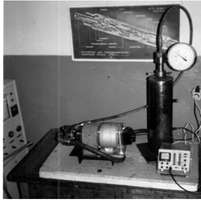
Рисунок 3.2 – Фотографія лабораторного стенду для дослідження роботи гідродинамічного кавітатора
