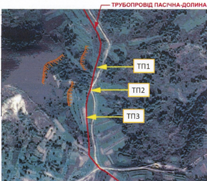
Рис. 3 Досліджувана ділянка газопроводу «Пасічна-Долина» Ду 500 на 5,1 км із підвищеним геодинамічним ризиком
