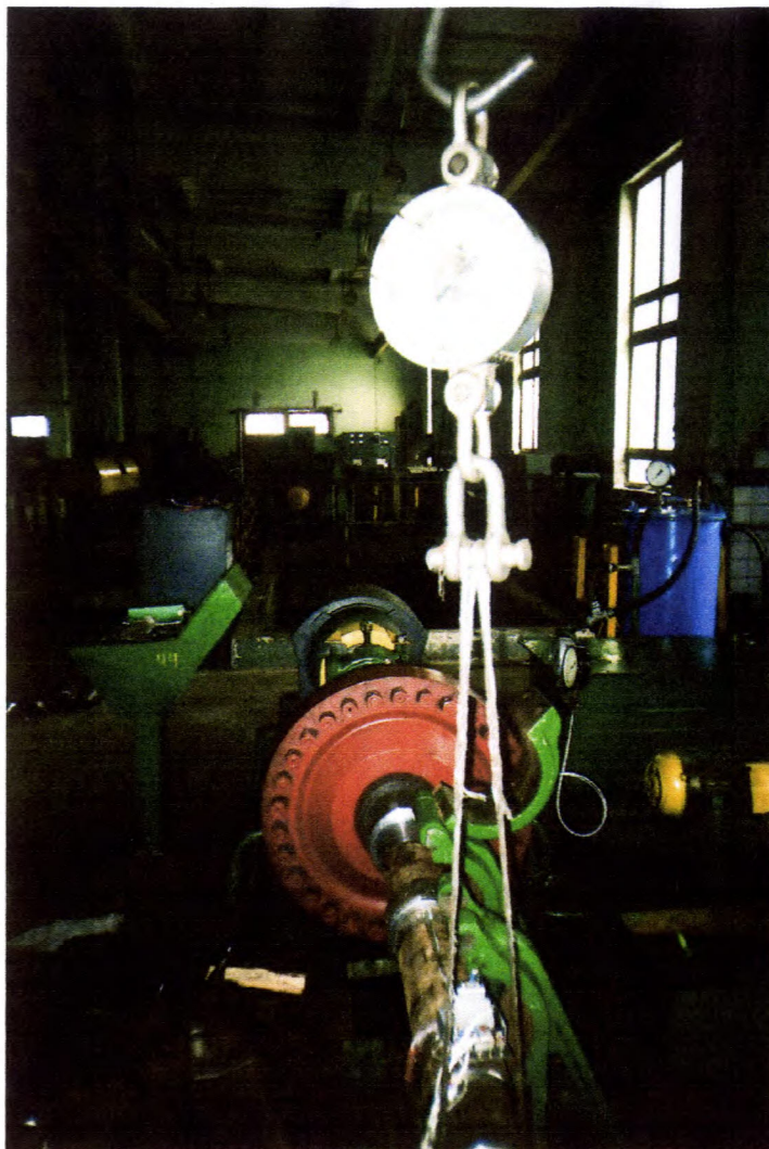
Рис. 3.27. Згин досліджуваного зразка різьбового з'єднання 3-121 з контролюванням згинального навантаження
