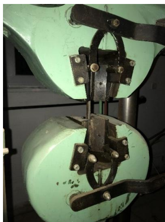
Рисунок 4.4 - Процес випробування металу досліджуваних НКТ на розтяг
