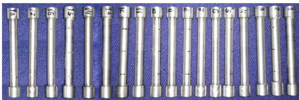
Рисунок 3.6 - Виготовлені зразки для руйнівних статичних випробувань на розтяг
