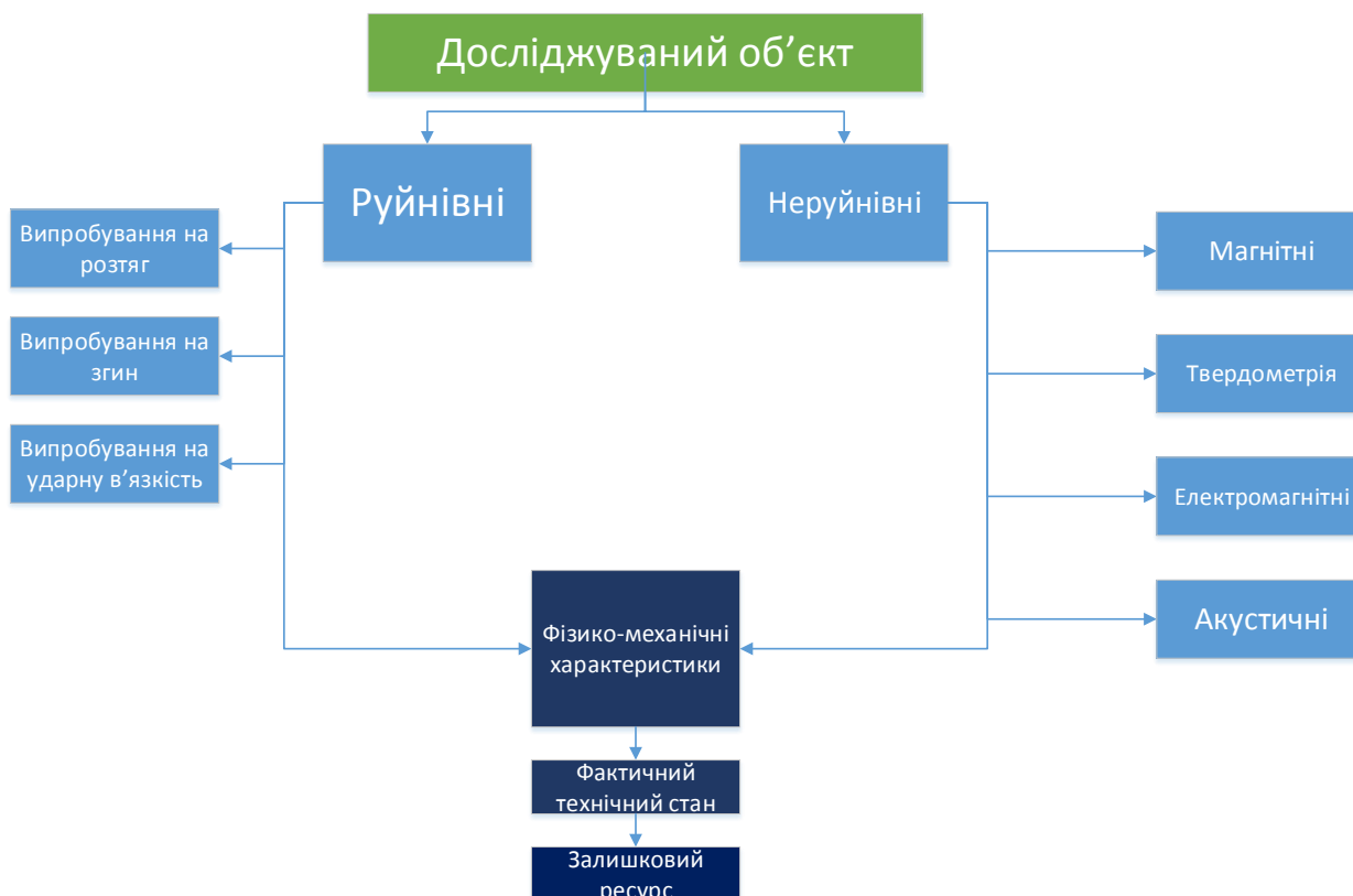
Рисунок 2.2 - Схема визначення фізико-механічних характеристик та залишкового ресурсу
