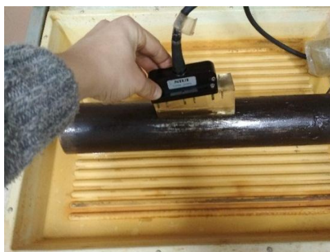
Рисунок 4.3 - Вимірювання інтегральної густини структурних шумів з використанням п'єзоперетворювача на фазованих ґратках на зразках НКТ
