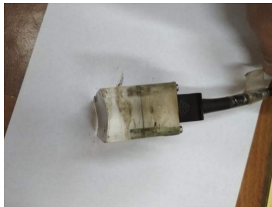
Рисунок 4.2 – Зовнішній вигляд перехідної призми для УЗ-контролю насосно-компресорних труб умовним діаметром 73 мм
