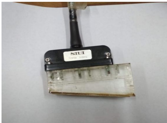
Рисунок 4.2 – Зовнішній вигляд перехідної призми для УЗ-контролю насосно-компресорних труб умовним діаметром 73 мм
