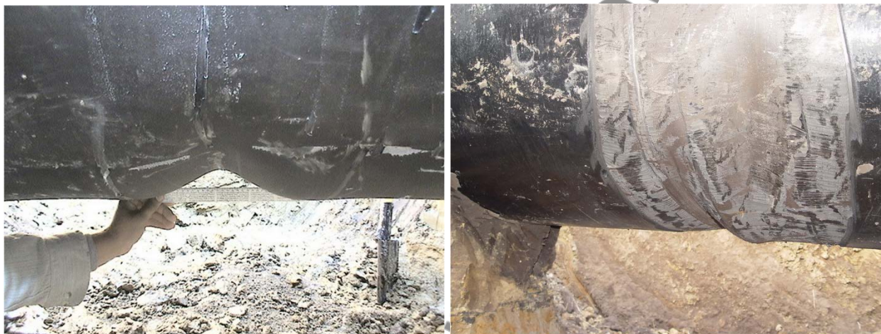
Рисунок 1.4 - Приклади дефектів геометрії трубопроводів
