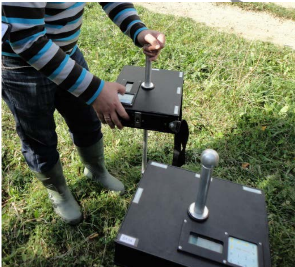
Рисунок 4.11 - Процедура проведення дослідження методом ПЕМПЗ на ділянці газопроводу «Пасічна-Долина»
