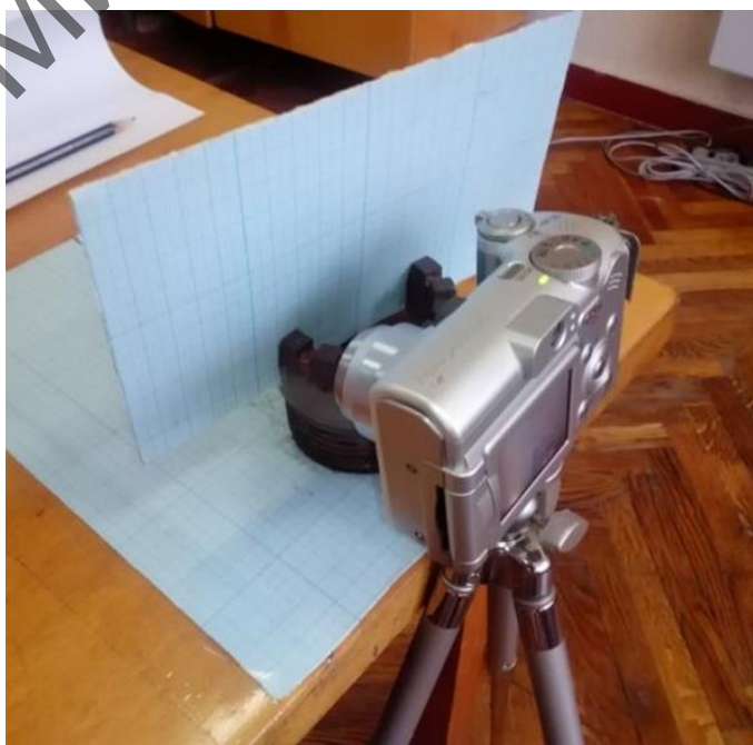
Рисунок 4.8 – Фіксація зношування за допомогою фотозйомки
