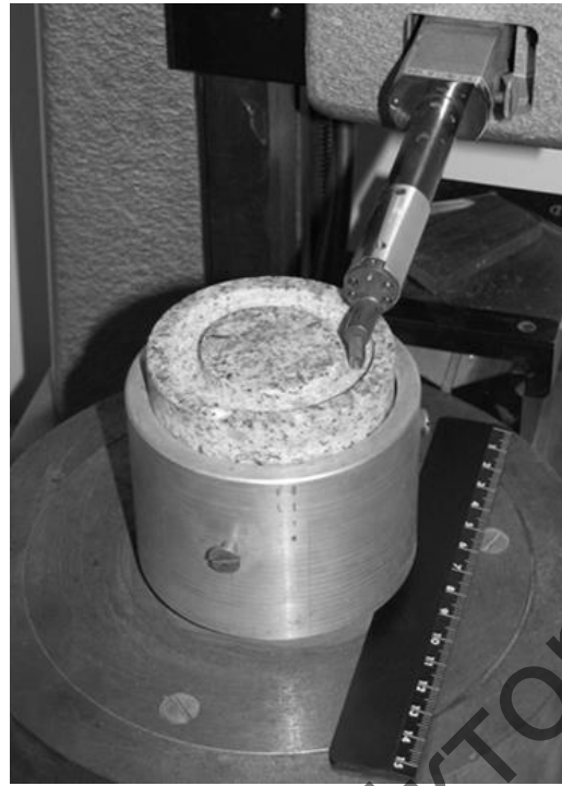
Рисунок 2.11 – Загальний вигляд процесу вимірювання параметрів шорсткості мікропрофілю поверхні вибою
