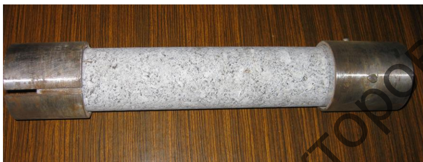
Рисунок 2.3 – Спеціальне пристосування для закріплення керну
