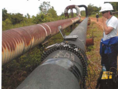
Рисунок 3 – Низкочастотная ультразвуковая диагностика
