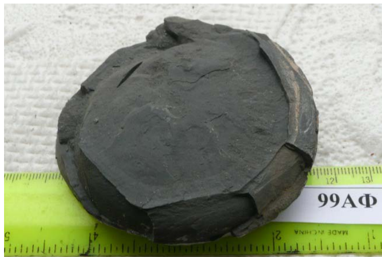
Рис. 255. Зразок 99 АФ. Чорний аргіліт. Свердловина Південноафанасіївська-11, інтервал 2889–2900
