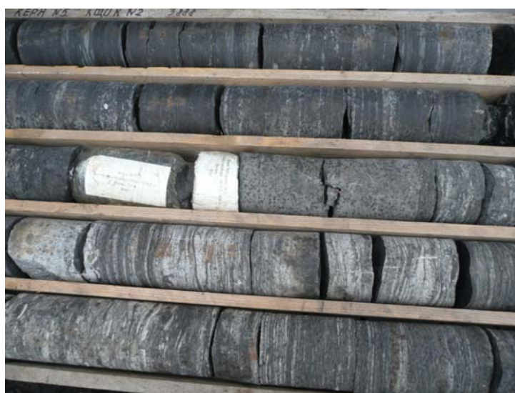
Рис. 102. Перешарування чорних і сірих аргілітів. Інтервал 3890,5–3892,0 м
