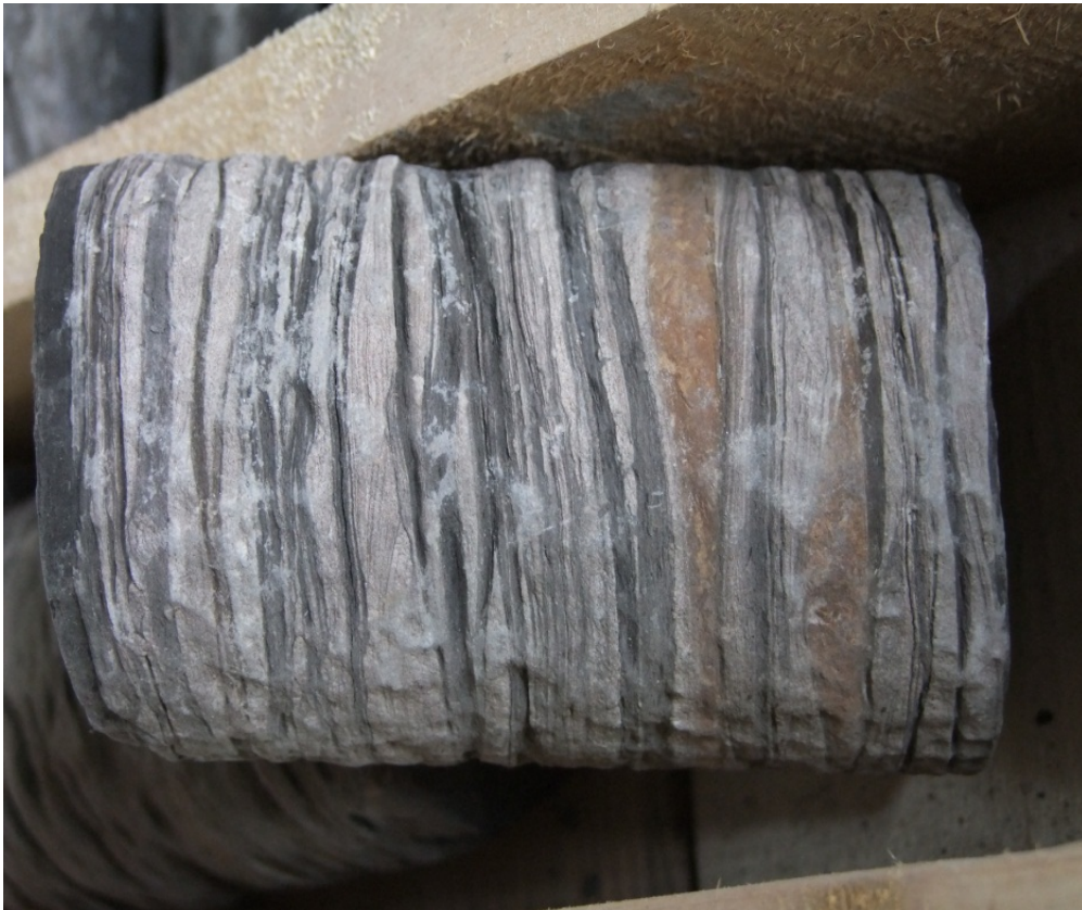
Рис. 54. Тонке перешарування чорних аргілітів і пісковиків (св. Євгенівська-1, інт. 1775–1783 м)
