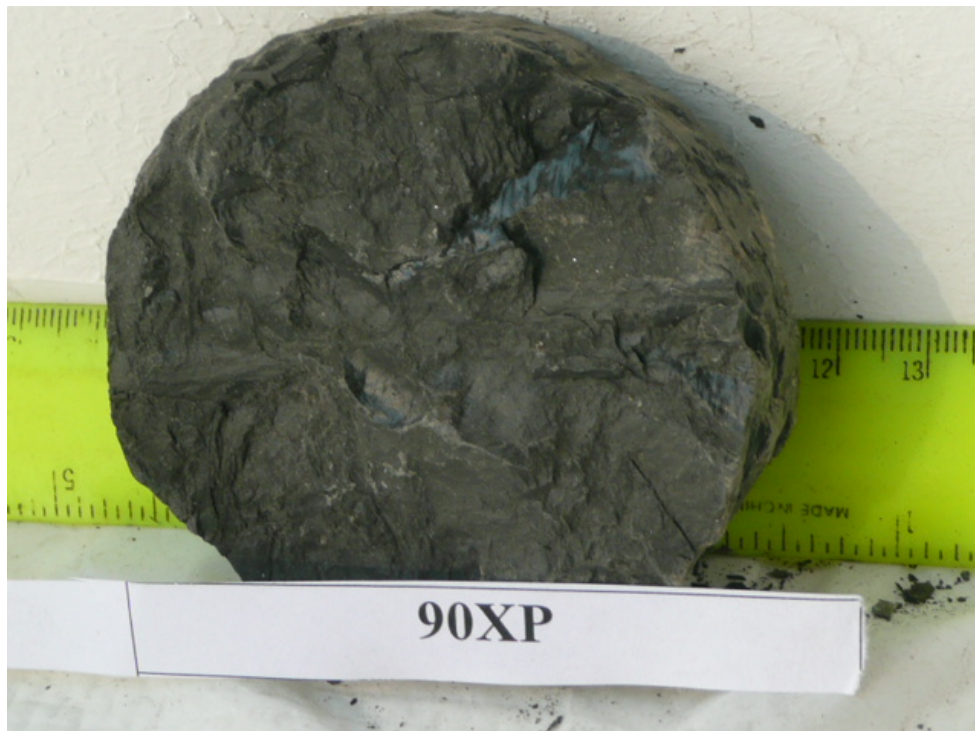
Рис. 243. Зразок 90 ХР. Чорний аргіліт. Свердловина Хорольська-398, інтервал 2641–2657 м
