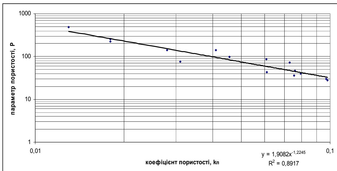
Рис. 293. Кореляційна залежність між коефіцієнтом пористості ( k_{п} ) та параметром пористості ( P ) – рівняння – Дахнова (лабораторні умови)
