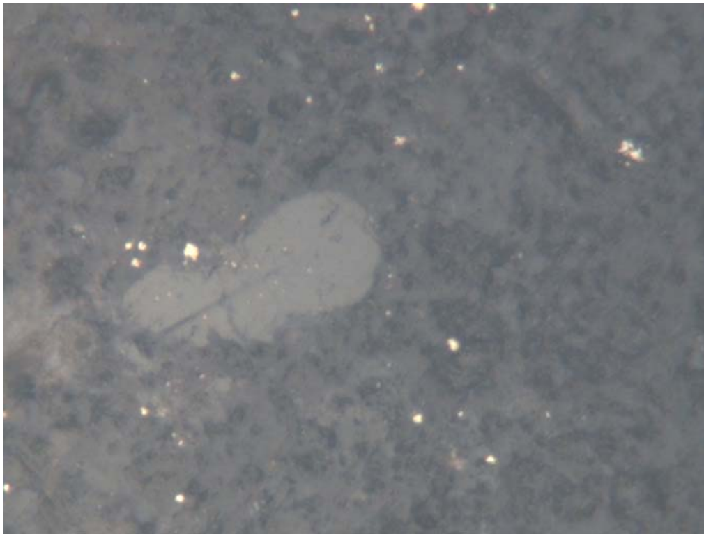
Рис. 55. Колодетриніт асоціює з глобулярним піритом. Аншліф 129 ЄВ
