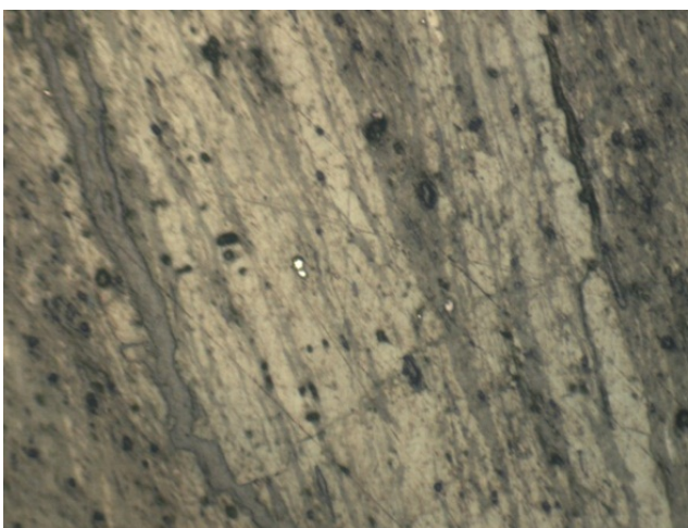
Рис. 270. Колодетриніт із включеннями глобулярного піриту. Аншліф 89 УШ
