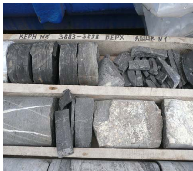
Рис. 101. Чорні аргіліти із прошарками мергелів. Інтервал 3883–3887 м
