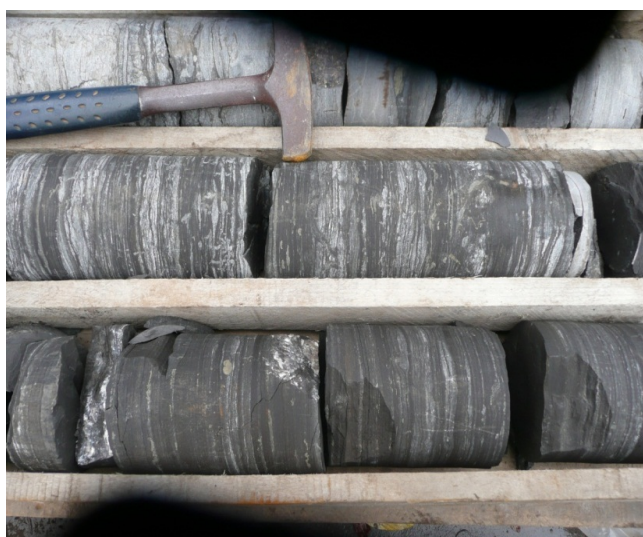
Рис. 100. Чорні аргіліти із прошарками мергелів. Інтервал 3883–3887 м
