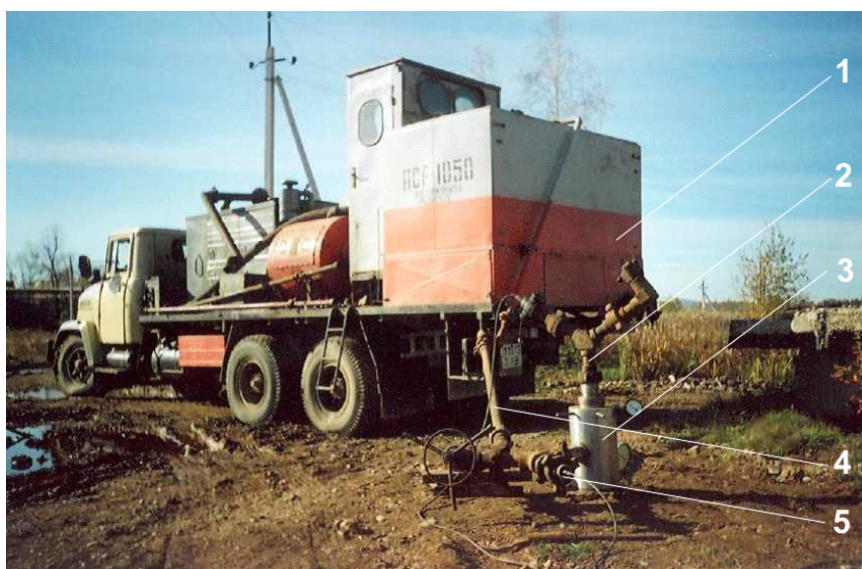
1 – насосний агрегат 4АН-700; 2 – нагнітальна лінія; 3 – експериментальна установка; 4 – викидна лінія; 5 – давач тиску типу “Viatran Model 5093 BPG AW200”
