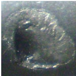
Рисунок 6 – Характерний вигляд локального втомного контактної руйнування поверхні бігової доріжки, утвореного ростом системи тріщин від підповерхневого дефекту в цементованому шарі \times 10\mu
