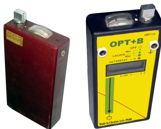
Рисунок 4 - Портативні прилади типу ОРТ і ОРТ+В для визначення розміщення трубопроводів (струмопроводів) і контролю ЕХЗ
