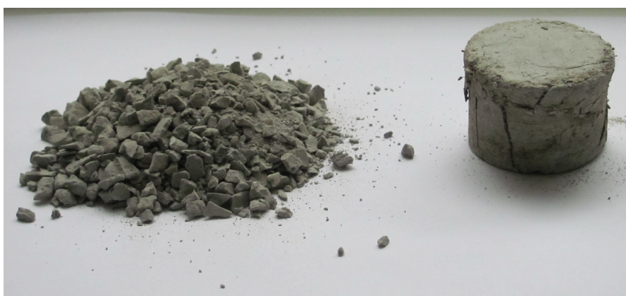
Рисунок 6 — Результат дроблення цементного каменю без домішок (з ліва) та з додаванням 1% ППФ-4 (з права) після 22-ох ударів
