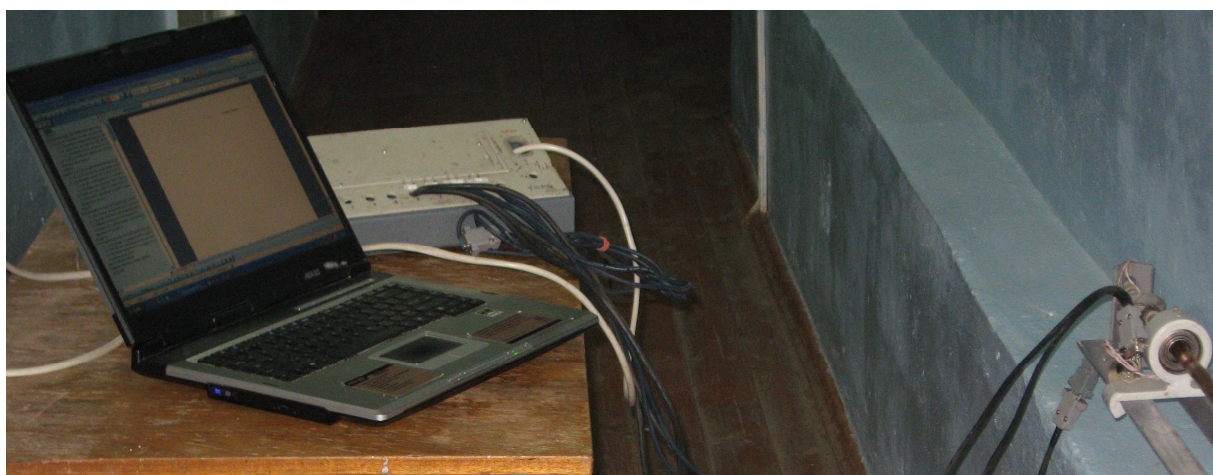
Рисунок 6 – Облаштування вимірювальної схеми експериментального стенда для дослідження неорієнтованих КНБК
