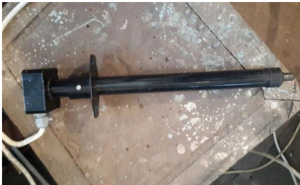
Рисунок 6 – Захисний ковпачок для інсталяції кисневого зонду на різні типи котлоагрегатів
