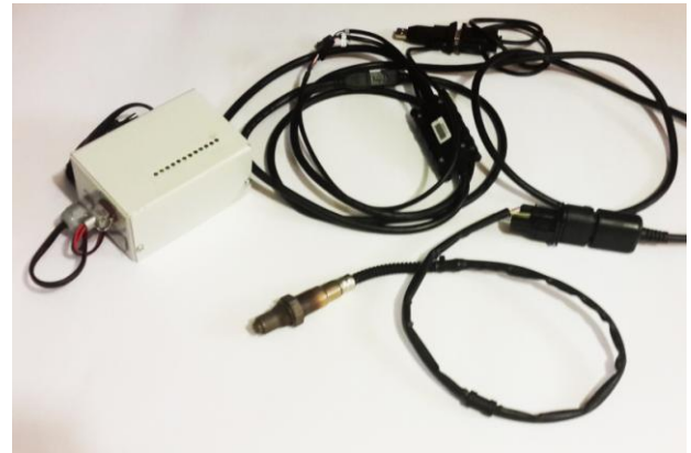
Рисунок 5 – Портативна система контролю якості процесу горіння на базі широкосмугового кисневого зонду та цифрового альфа-індикатора
