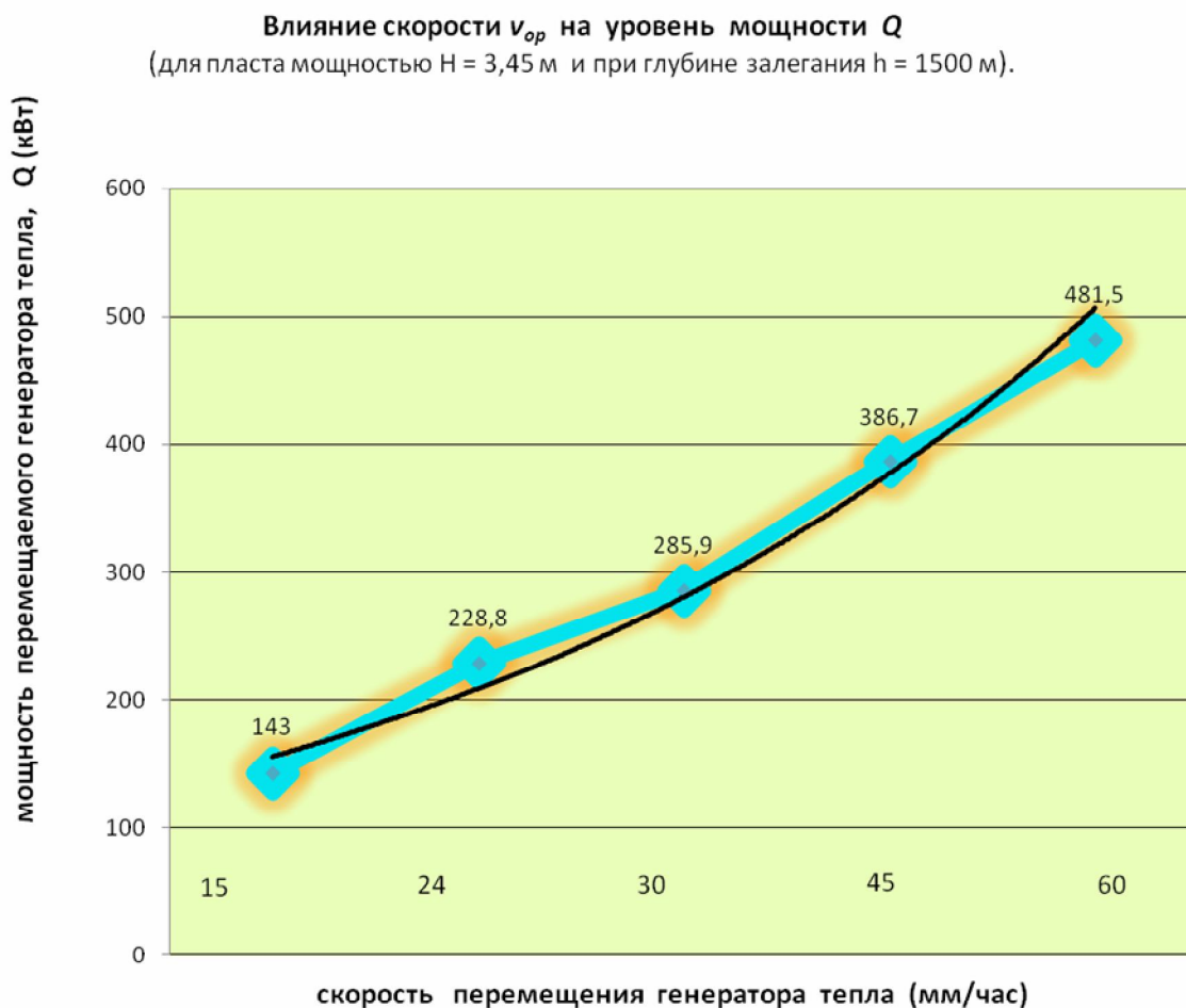
Рисунок 6 – Зависимость тепловой мощности нагрева от скорости перемещения точечного генератора тепла внутри пласта ГС
