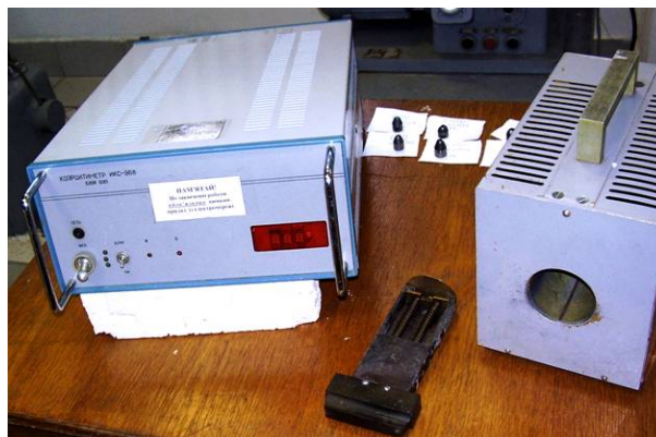
Рисунок 1 – Прилад ИКС-968 і випробувані на коерцетивну силу твердосплавні зубки
