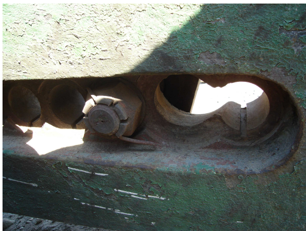
Рисунок 2 – Руйнування стінки між сусідніми отворами кривошипа
