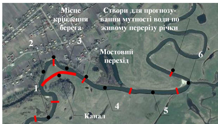
Рис. 2. Схематичне розташування створів та розрахункових блоків ділянки р. Горинь, де прогнозувалися зміни мутності
