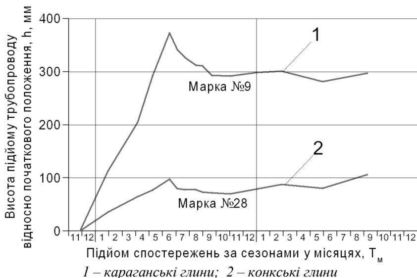
Рисунок 4 – Графіки максимальних деформацій поверхневих марок для глин
