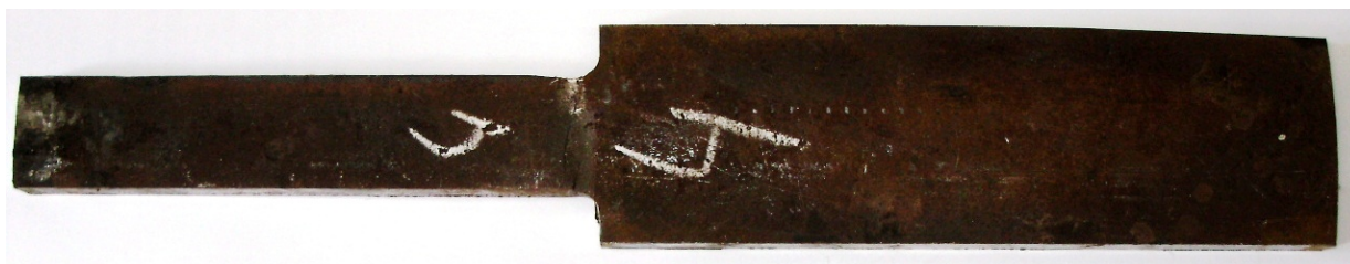
Рисунок 1 – Загальний вигляд зразка для випробувань на втомну міцність
