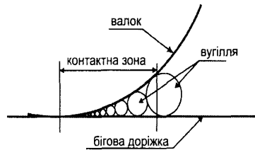
Рис.5. Схематичне зображення процесу помолу вугілля у ВВМ
