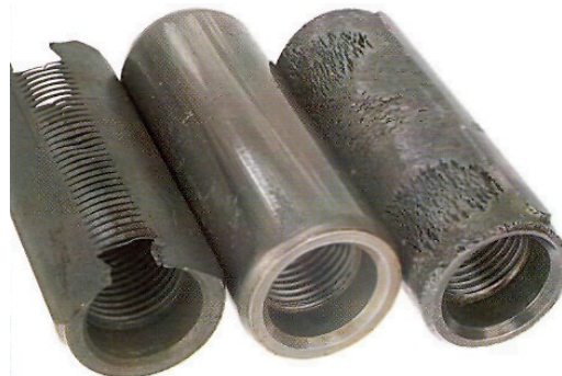
Рисунок 2 — Поломки і пошкодження насосних штанг і муфт
