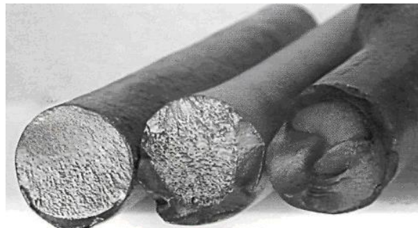
Рисунок 5 — Втомні поломки штанг по тілу від згину
