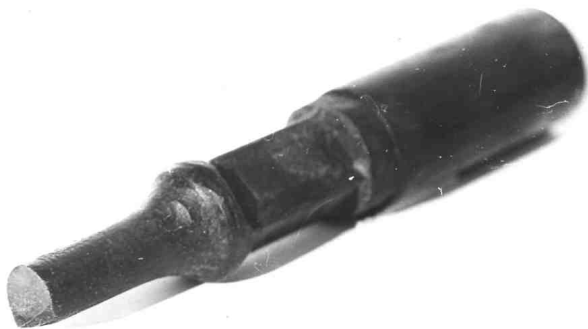
Рисунок 4 — Механічна поломка штанги
