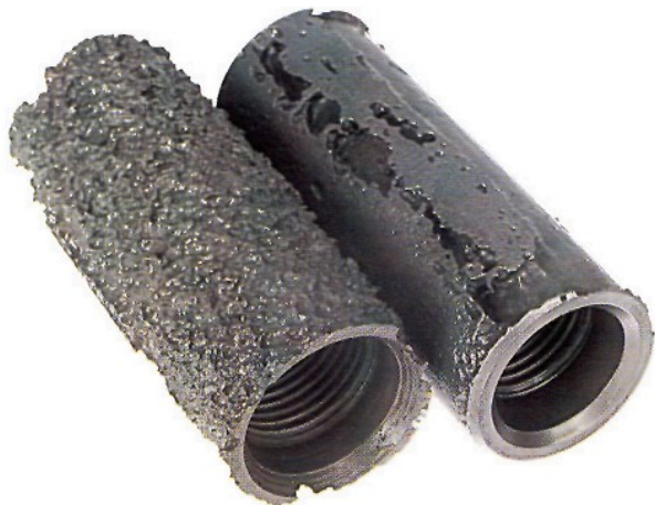
Рисунок 8 — Типові приклади \text{CO}_2 -корозії на муфтах
