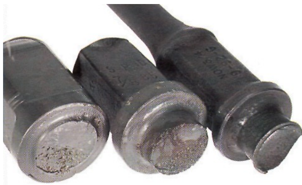
Рисунок 6 – Поломки головок НШ внаслідок втрати затягнення різьбового з'єднання
