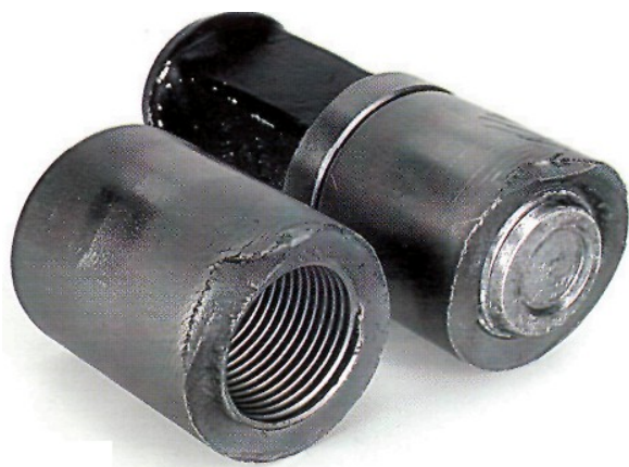
Рисунок 7 — Поломки муфти від втрати затягнення різьбового з'єднання
