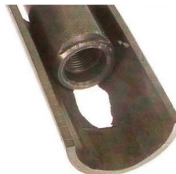
Рисунок 3 — Пошкодження від удару муфти об НКТ
