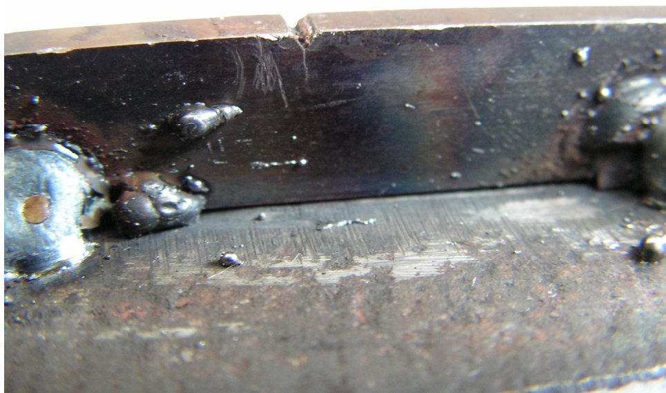
Рисунок 3 — Загальний вигляд навантажувальної пластини з привареним індикатором
