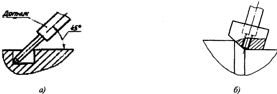
Рис. 4. Положення вихрострумowego датчика при контролі кутових зон пазів (а) та галтельних переходів (б)
