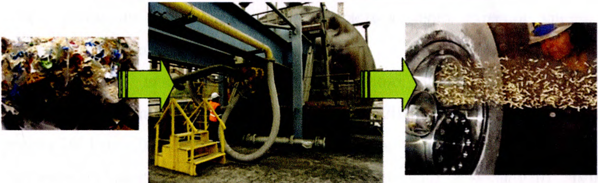
Рис. 5.2. Приймальний склад (а) та спосіб подавання подрібненого твердого альтернативного палива ТП-1 в обертову випалювальну піч
