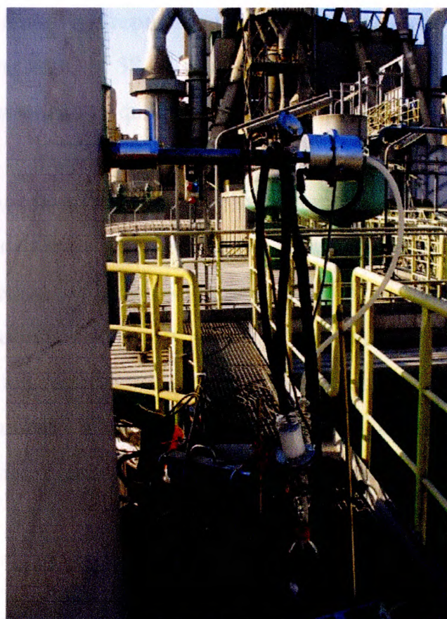
Рис. 4.17. Відбирання зразків відхідних газів з вугільного млина (а) і обортової печі (б) цементного заводу
