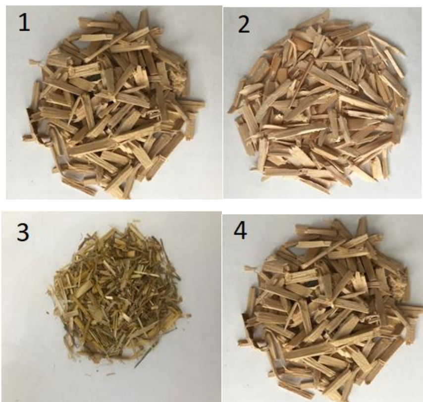
Рисунок 3.2 – Зовнішній вигляд зразків торефікованої біомаси: 1 – верба; 2 – сосна; 3 – пшенична солома ; 4 – бук.
