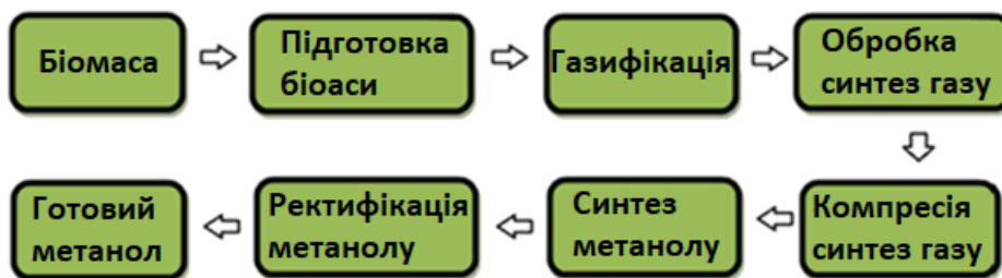
Рисунок 5.3–Технологічна схема виробництва метанолу з біомаси [9].
