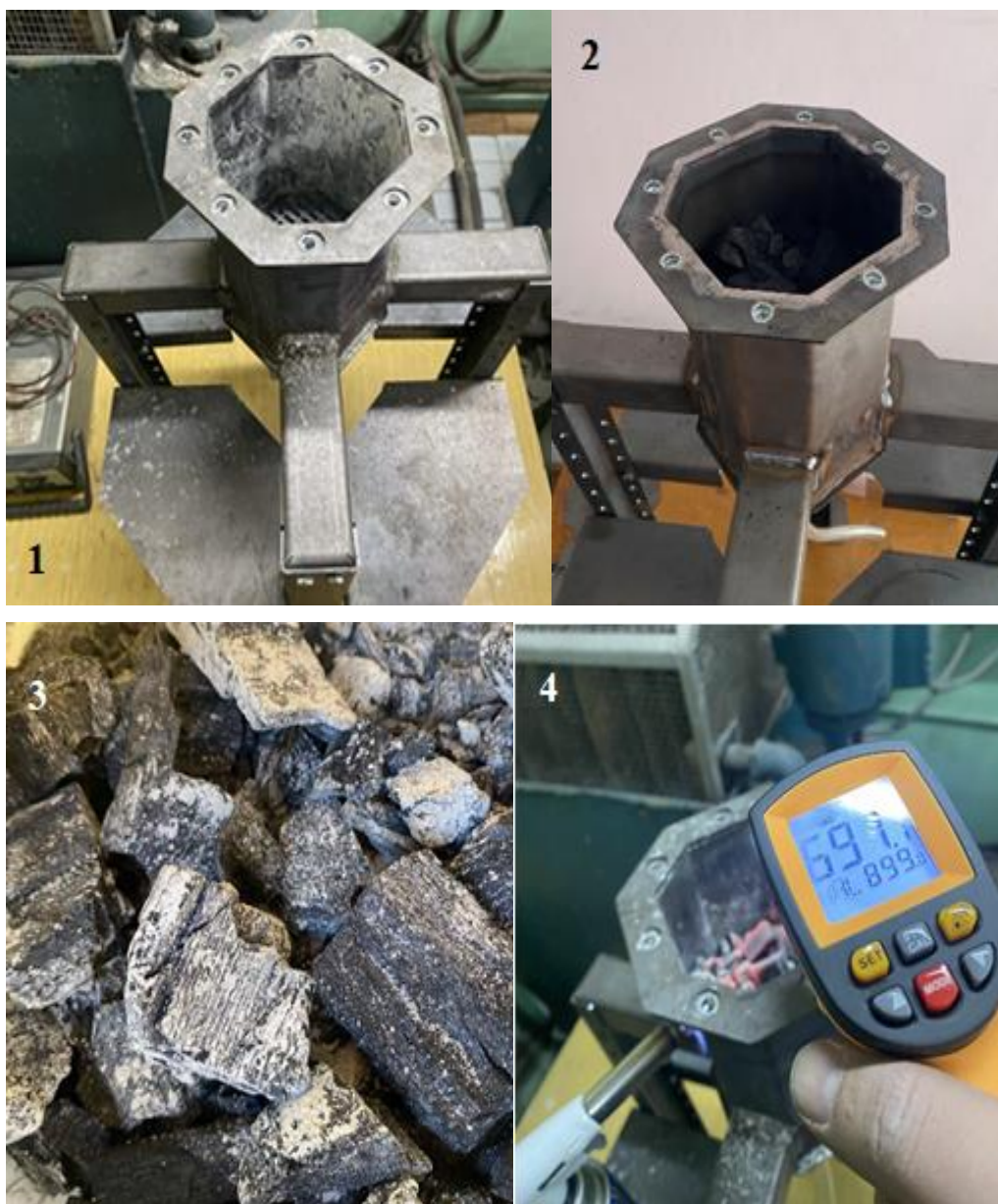
Рисунок 4.14 – Реактор для збагачення синтезгазу: 1– встановлення реактора; 2 – встановлення вугілля в середину реактора; 3 – додавання негашеного вапна до вугілля; 4 – нагрівання до робочої температури.
