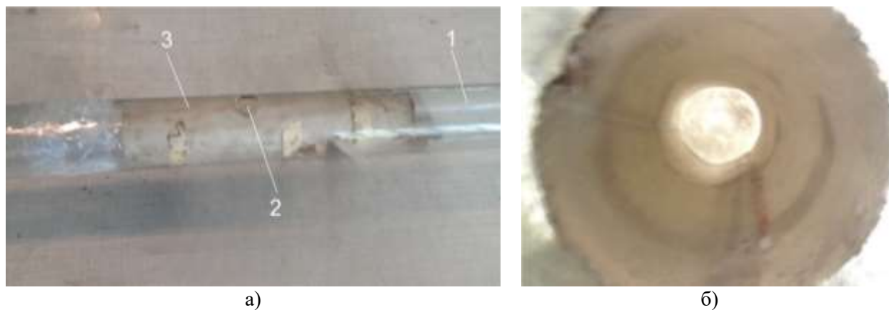
а) – випробування внутрішнім тиском; б) – внутрішньотрубний фотознімок ремонтного бандажа 1 – скляна труба; 2 – отвір; 3 – ремонтний бандаж
