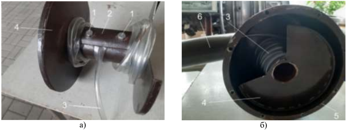
а) – прикріплена до валу барабана гнучка трубка; б) – поміщений у циліндричну герметичну камеру барабан із намотаною гнучкою трубкою; 1 – болт; 2 – пластина; 3 – гнучка трубка; 4 – барабан; 5 – герметична камера; 6 – трубна котушка
