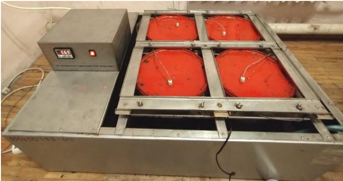
Рис. 5.20. Установка для лабораторного біокомпостування органічних сумішей в роботі (29.07.2023, 32-а доба компостування; T_m = 57\text{ }^{\circ}\text{C} )
