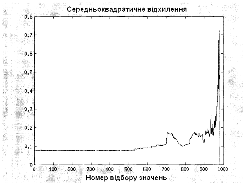
Рисунок 2.15 – Залежність середньоквадратичного відхилення вібропереміщення підшипника № 1 від номеру відбору значення
