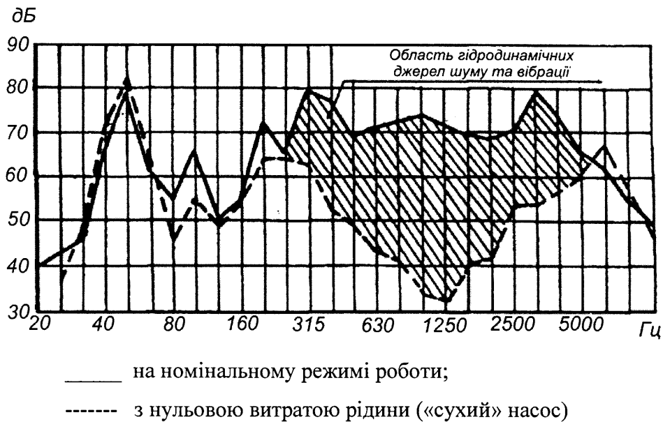
Рис. 2.1. Спектри віброприскорень корпусу підшипника ВНА при різних режимах роботи
