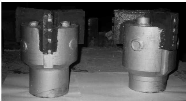
Рисунок 6.3 - Загальний вигляд бурових доліт: ліворуч – трилопатеве долото з гідромоніторними насадками, праворуч – трилопатеве долото з гідродинамічними пульсатором
