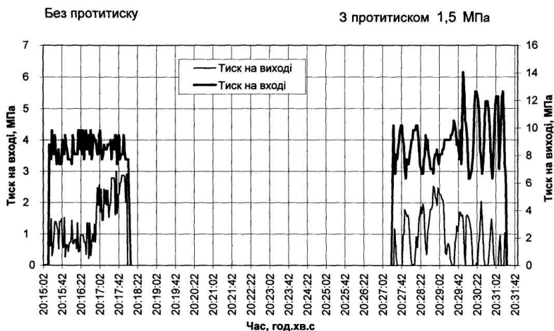
Рисунок 5.6 - Графічна інтерпретація результатів дослідження роботи пульсатора з діаметром насадки 14 мм на глинистій промивальній рідині
