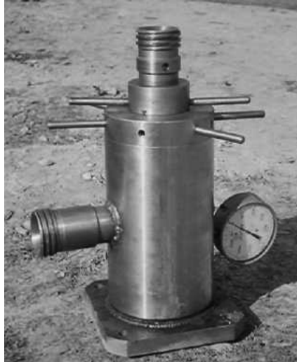
Рисунок 5.3 - Загальний вигляд експериментальної установки для дослідження кавітаційно-пульсаційних потоків
