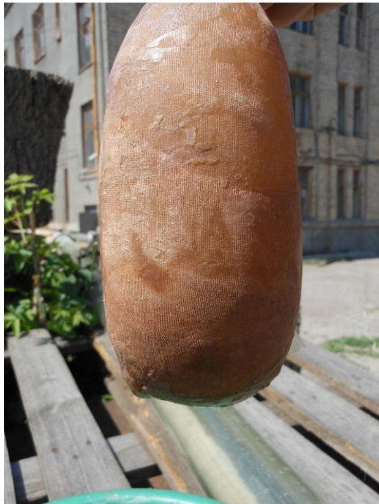
Рисунок 3.1– Пружно-полімерна композиція в нещільному синтетичному матеріалі
