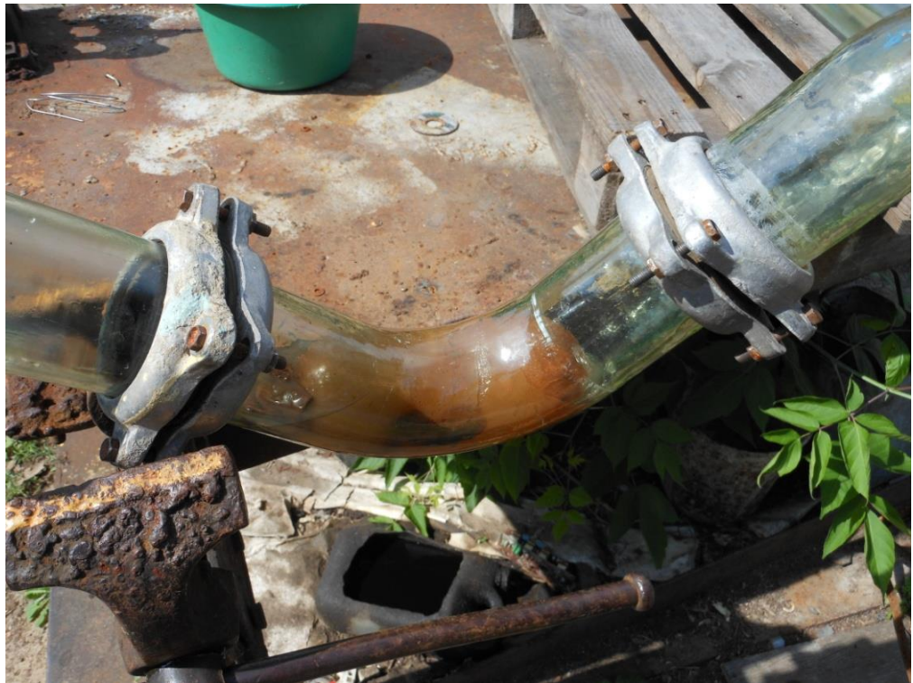
Рисунок 3.3 – Пружно-полімерна композиція в нещільному синтетичному матеріалі на початку трубопроводу
