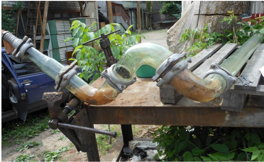
Рисунок 3.6 – Розчин із води і глини в порожнині трубопроводу
