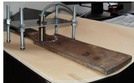
Рисунок 13 – Стенд для сканування дефектів внутрішньої поверхні зразка
