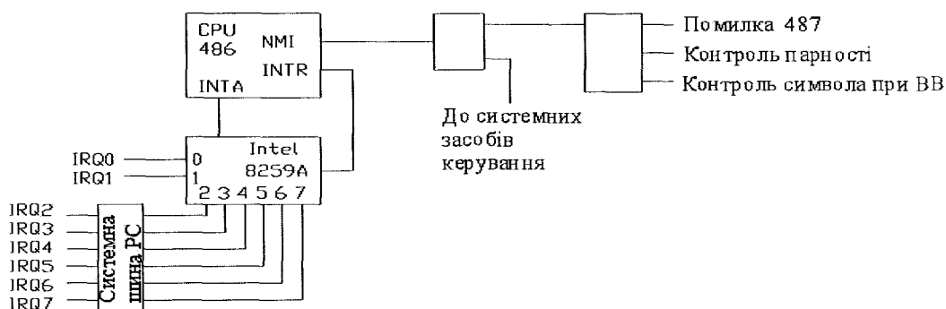
Рис. 3.9. Структура переривань, які подаються на 8259А
