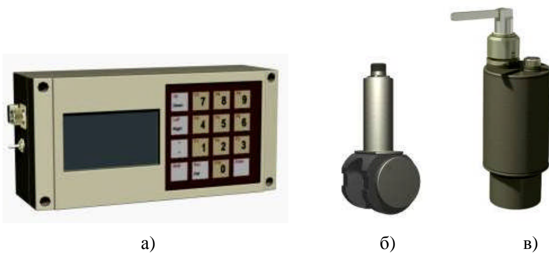
а) електронний блок; б) давач навантаження; в) давач генерації та прийому акустичних сигналів
