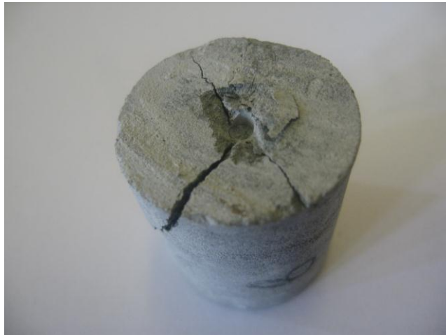
Рисунок 2.9 – Зруйнований взірець після втискування в нього циліндричного штампа
