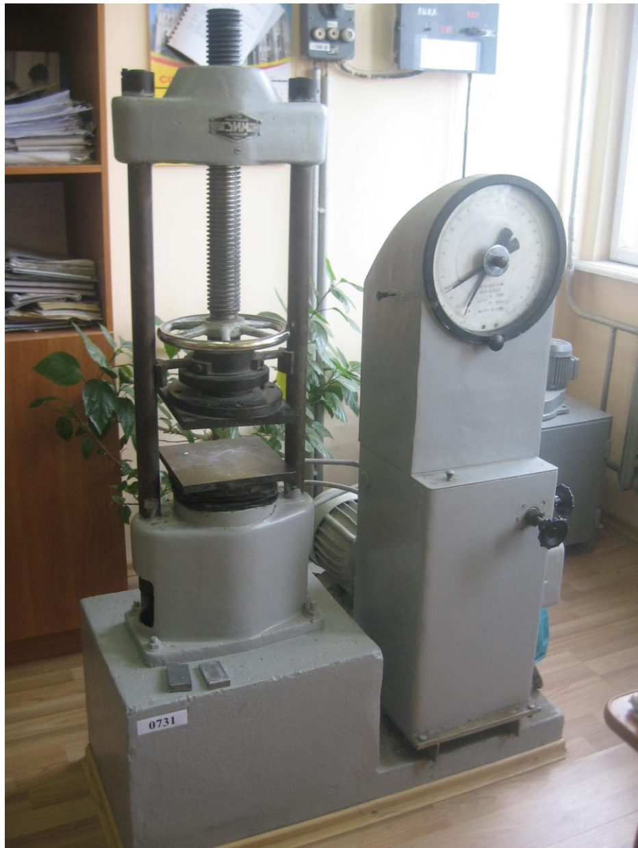
Рисунок 2.8 – Гідравлічний прес ПСУ-10 для проведення експериментальних досліджень зразків керну
