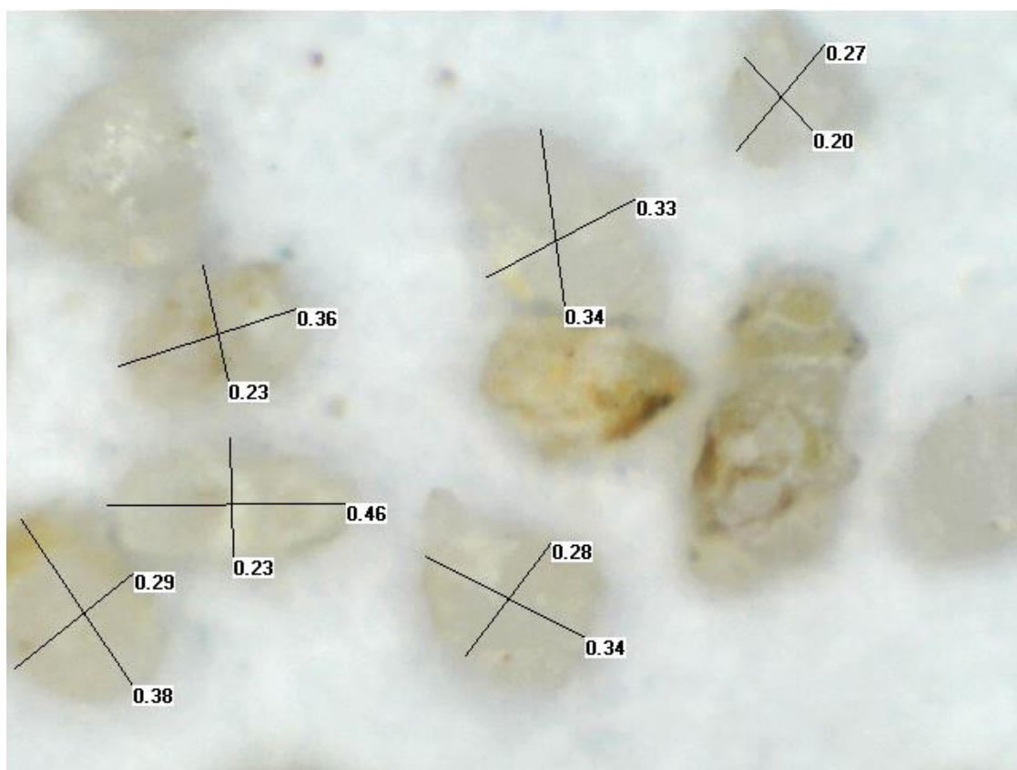
Рисунок 2.3 – Розміри частинок піску, які виносились з моделі свердловини в діапазоні швидкостей руху газового потоку 1,876 – 3,282 м/с
