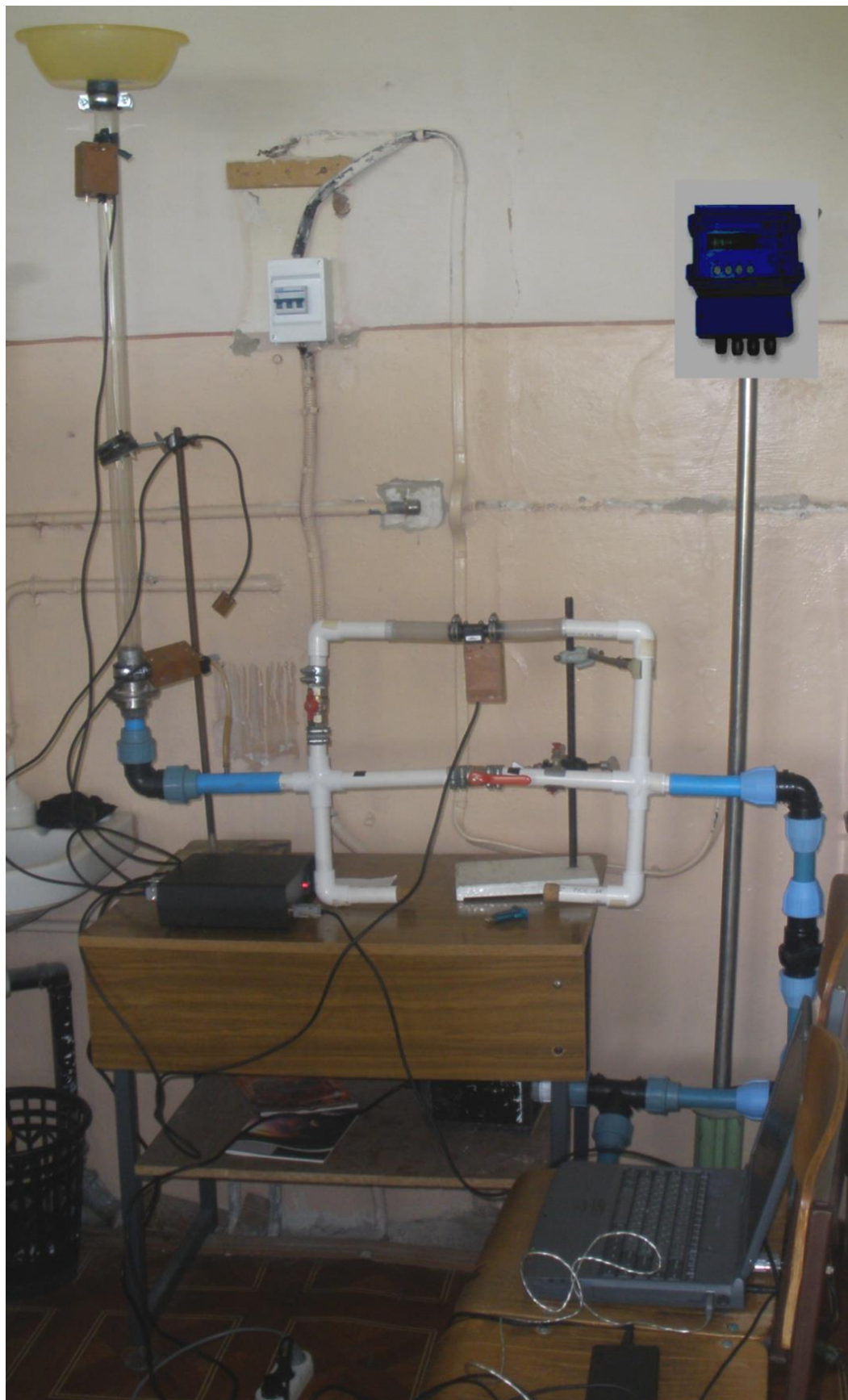
Рисунок 2.2 – Загальний вигляд експериментальної установки для дослідження умов винесення частинок піску із моделі свердловини
