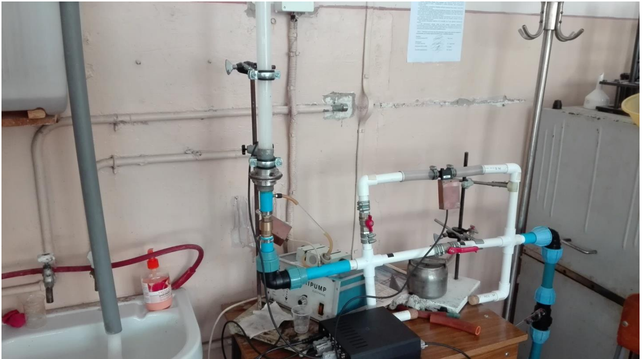
Рисунок 2.13 – Загальний вигляд експериментальної установки для дослідження умов винесення частинок піску із моделі свердловини
