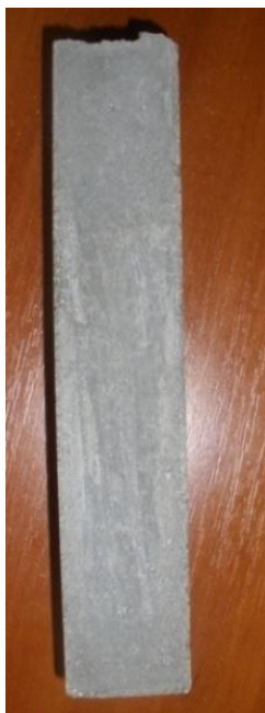
Рисунок 4.4 – Зразок взірця цементного каменю на основі ТС-100 + спучений перліт + неіоногенна ПАР + суперпластифікатор (у віці 72 години)
