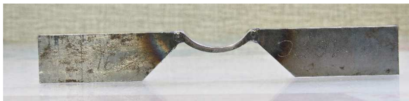
Рисунок 1 – Загальний вигляд зразка для дослідження зародження та розвитку поверхневих тріщиноподібних дефектів за циклічних навантажень
