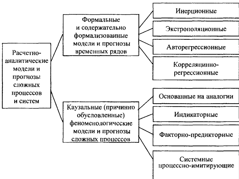
Рис. 2.1. Общая классификационная схема расчетно-аналитических моделей и прогнозов сложных процессов и систем
