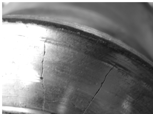
а – крихке руйнування перевантаженої ділянки уступу цапфи з випаданням запресованої в торець твердосплавної пластини; б – утворення тріщин і сколювання наплавки на торці цапфи
