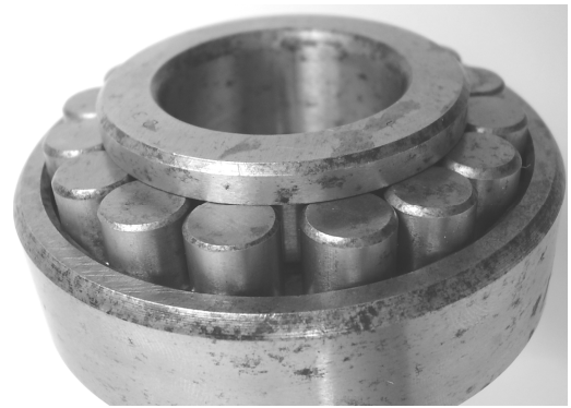
Рисунок 3 — Нерівномірність зазорів між тілами кочення при їх перекочуванні в роликовому безсепараторному підшипнику
