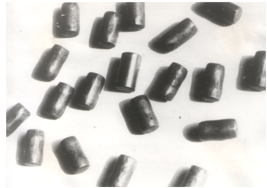
Рисунок 4 — Характерний знос і деформація роликів ряду опори долота
