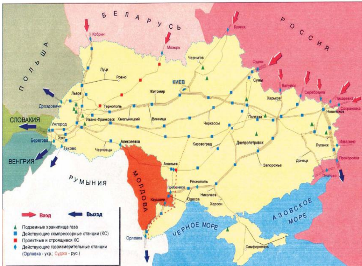
Рис. 1 Схема газотранспортної системи України [Дж. 24]
