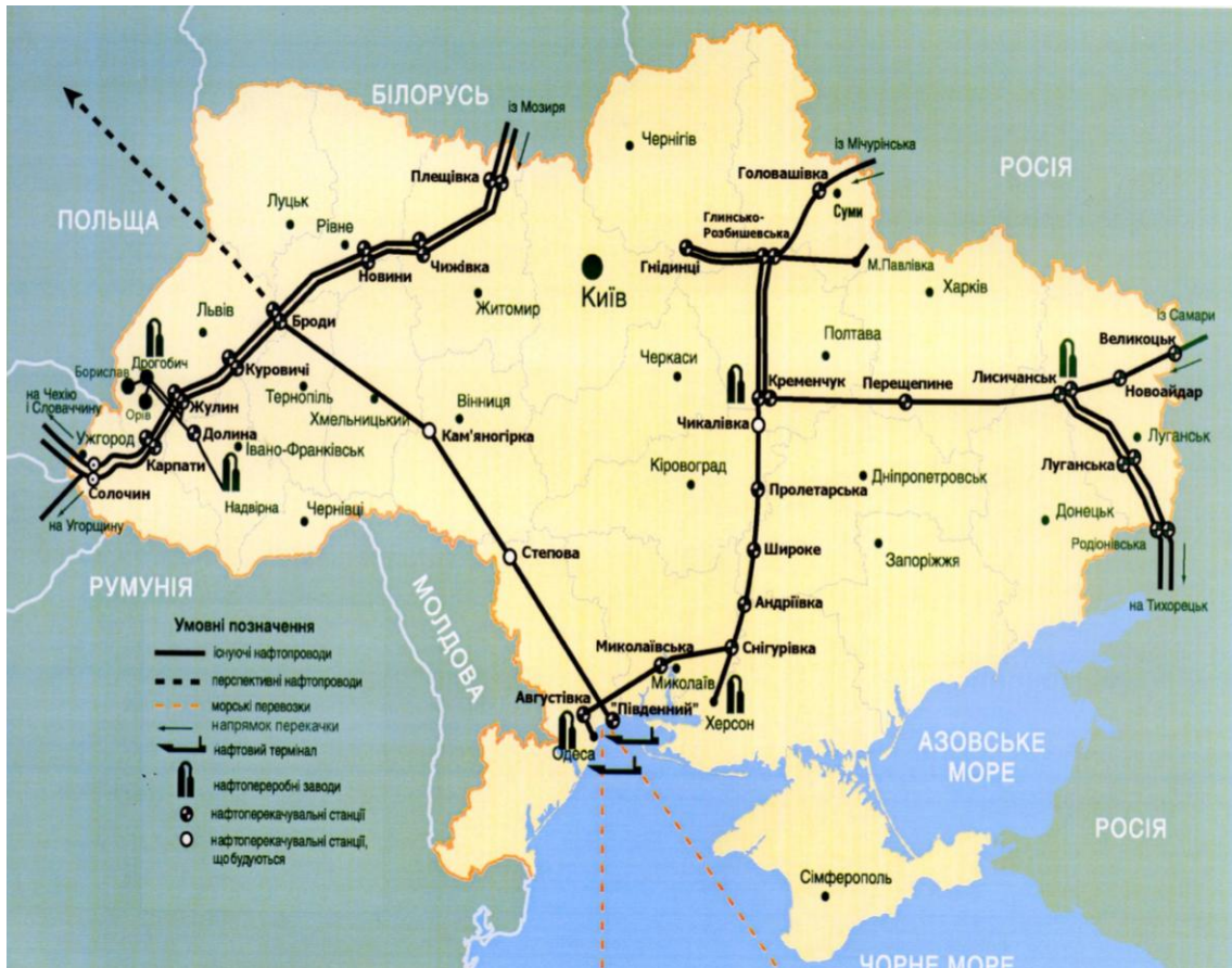
Рис. 2 Схема нафтопроводів України. [Дж. 39]
