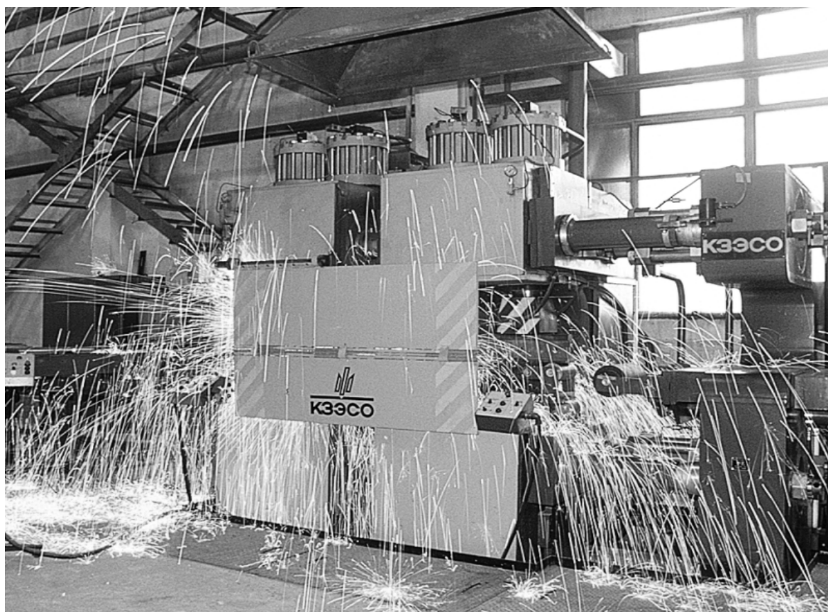
Рисунок 5 – Процес зварювання хрестовини стрілкового переводу
