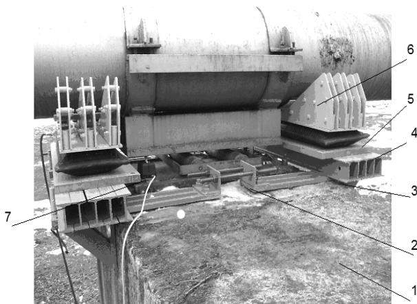
1 - бетонна опора; 2 - консоль; 3 - опорні балки; 4 - опорна плита; 5 - пневмоподушка; 6 - призма; 7 - індикатор висоти підйому
