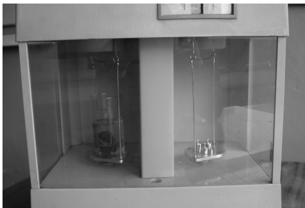
Рисунок 4 – Зовнішній вигляд налаштованої ваги ВЛР – 200 для визначення параметрів зношування дослідних взірців
