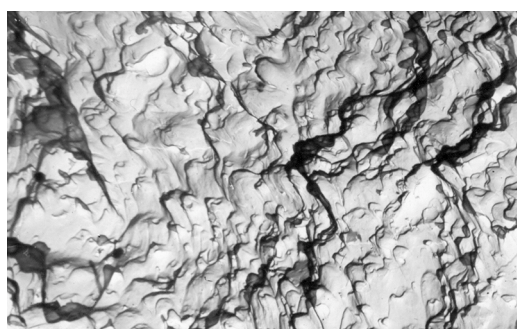
Рисунки 4 – Фактографічні особливості зламі ударних зразків неексплуатованого (а) та експлуатованого (б) МШ. x3000
