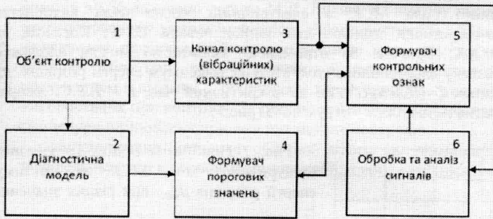
Рис. 5. Гнучка функціональна блок-схема МСК технічного стану СПУ у загальному виді.
