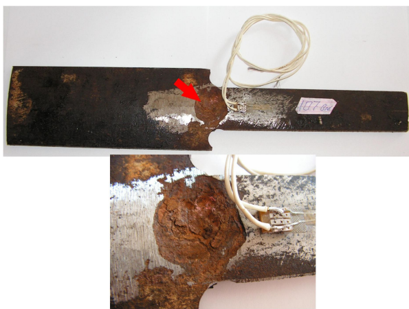
Рисунок 3 – Експериментальна модель-“вирізка” із локальним корозійним дефектом
