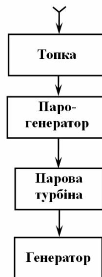
Рисунок 1 — Блок-схема технологічного процесу виробництва електроенергії на теплових станціях
