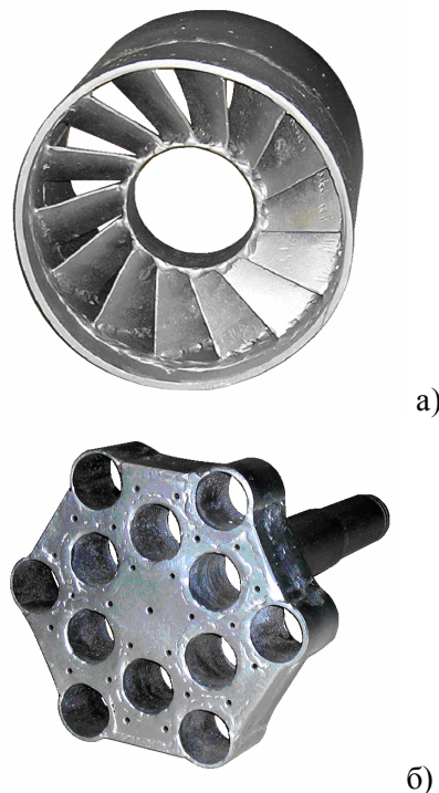
Рисунок 6 — Загальний вигляд штатного реєстрового пальника (а) камери згорання ГПА ГТК-10 та трубчастого пальника (б) для першого варіанту модернізації камери згорання цього агрегату
